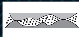
金属表面に5~10ナノメートルの極小ダイヤモンドとグラファイトがコーティングされ真実接触面が拡大し、金属表面を滑らかにします
