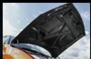
300km/h領域の風圧を想定して高強度のカーボンリブを設定。なお、エアロボンネット裏面には脱着可能な雨天用レインガードが付属します。
