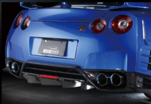
床下冷却性能の向上と空気抵抗の低減を目的に開発した、純正リヤバンパー対応のリヤアンダーバンパー。Ver.1とVer.2の違いはバンパーの出幅です。Ver.1は'08年モデルから15mmロング仕様となり、Ver.2はさらに10mm伸ばした25mmロング仕様となります。なお、取り付けは純正リヤバンパーフェンシアと交換するだけのボルトオン設計です。
