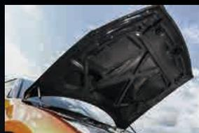
300km/h領域の風圧を想定して高強度のカーボンリブを設定。なお、エアロボンネット裏面には脱着可能な雨天用レインガードが付属します。
