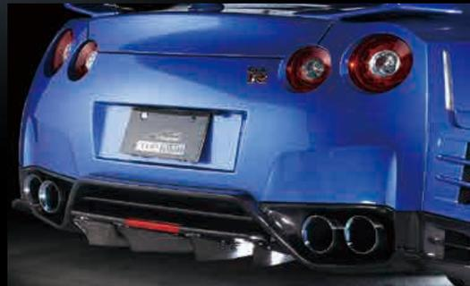
床下冷却性能の向上と空気抵抗の低減を目的に開発した、純正リヤアンダーバンパー。Ver.1とVer.2の違いはバンパーの出幅です。Ver.1は'08年モデルから15mmロング仕様となり、Ver.2はさらに10mm伸ばした25mmロング仕様となります。なお、取り付けは純正リヤアンダーフェンシアと交換するだけのボルトオン設計です。
